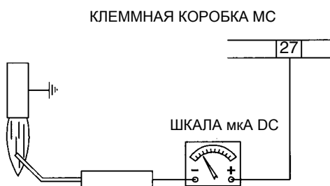
Рис. 28 - Контроль пламени с помощью электрода
